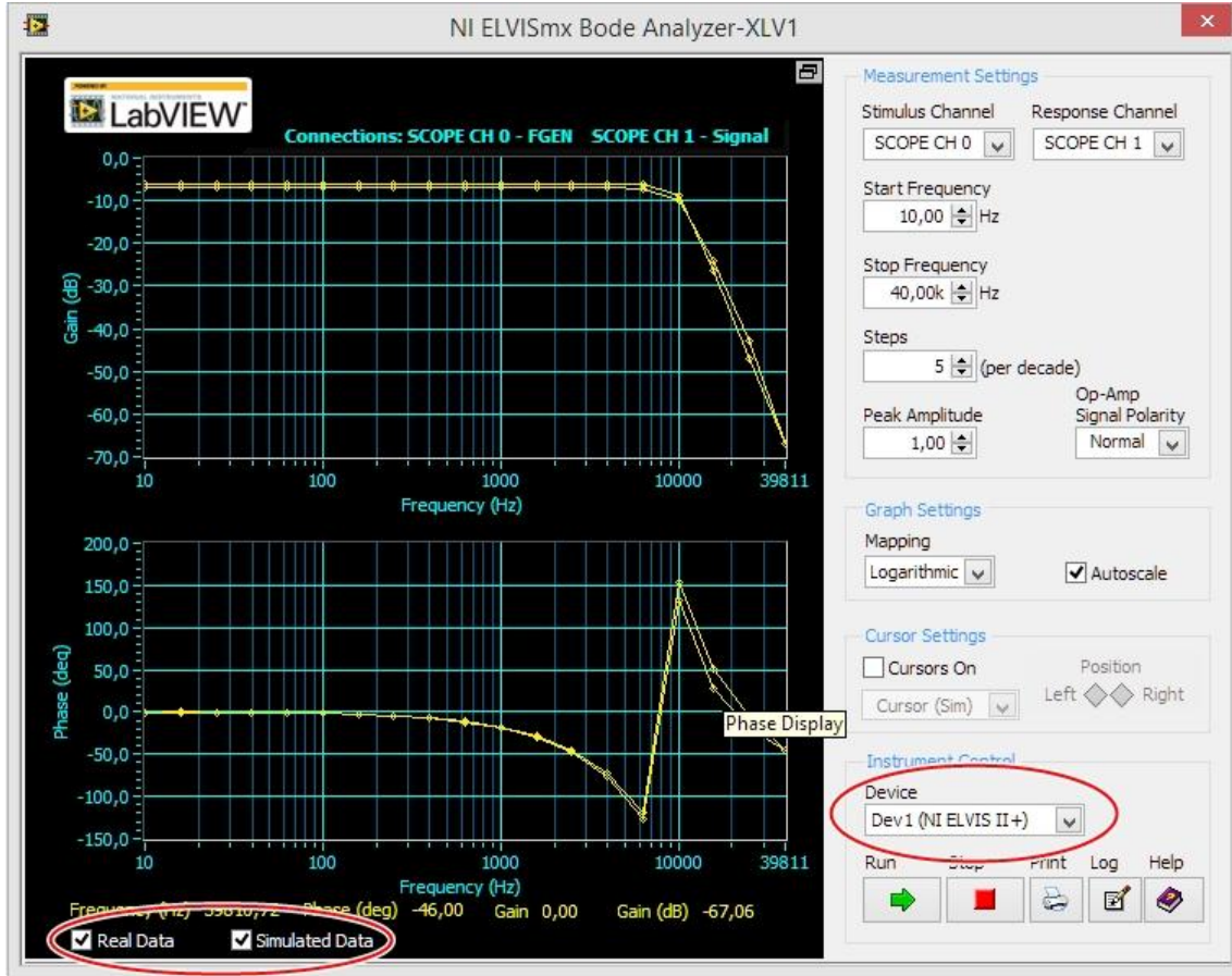
Şekil 12. Alçak-geçiren süzgeç devresi gerçek ölçüm sonuçları
