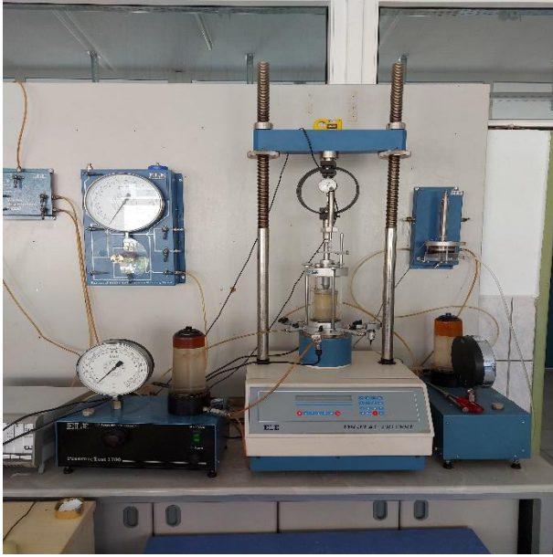
Şekil 5. Üç Eksenli Basınç Deney Sistemi
