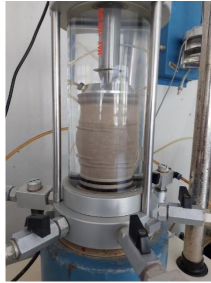
Şekil 8(b) Statik Sıvılaşma Gerçekleşmiş Numune
