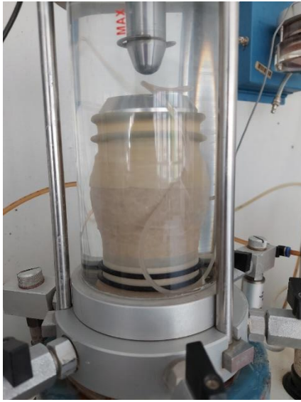
Şekil 8(a) Statik Sıvılaşma Gerçekleşmemiş Numune
