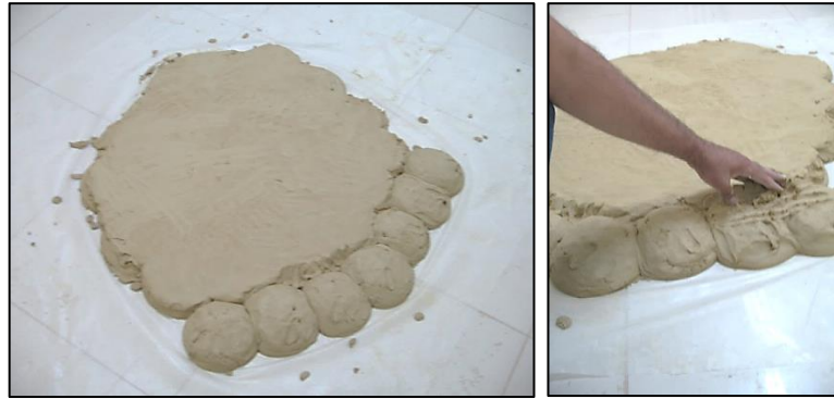
Görsel 6. Yere vurulmuş kil topları ve toplar yere vurulduktan sonra aralardaki boşlukların birbirine kaynaştırılarak doldurulması.
