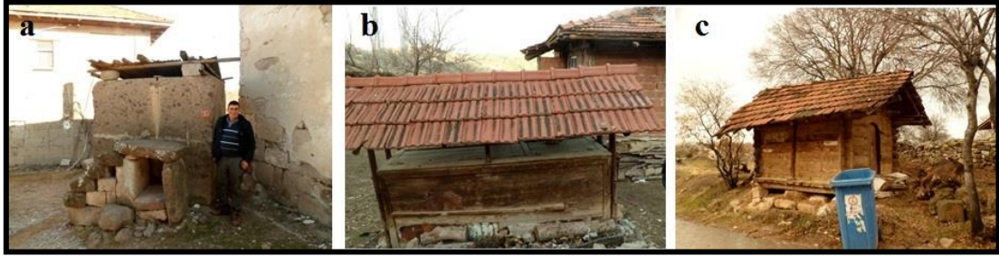
Fotoğraf 1: Uşak ilinde yapı malzemesi ve konumlarına göre ambar örnekleri. a-Taştan yapılmış ambar (Altıntaş köyü), b-Taşınabilir özelliğe sahip seyyar ambar, c-Evin dışında konumlandırılmış meydan ambarı.
