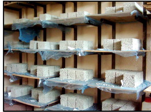
Şekil 1. Pomza agregalı bimsbeton numunelerinin görünümü.
