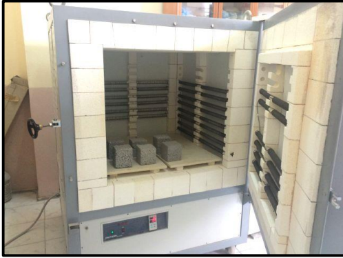
Şekil 3. Kül fırını ve bimsbeton örnekleri
