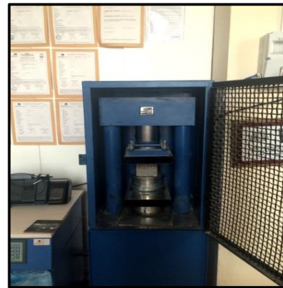
Şekil 2. Bimsbeton örneklerinin basınç dayanım analizi
