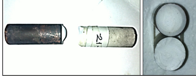
Şekil 3. Kesme testi sonrası Cu ve porselen numuneler.
