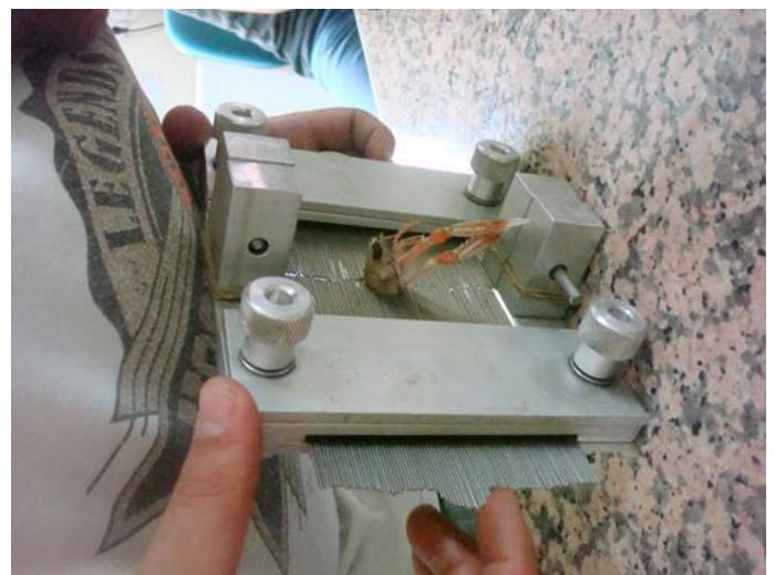
Şekil 3. Norveç istakozu bireylerinin mekanik morfometre ile istenilen bölgelerdeki vücut kesitleri şekillerinin belirlenmesi
