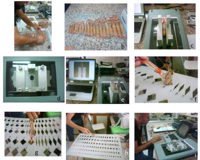
Şekil 2. Norveç istakozu boy ölçümlerinin değerlendirilmesine ilişkin işlem aşamaları (a: Bireylerin boy sırasına göre dizilişi, b: çalışmada kullanılan örnekler, c; morfometrik ölçümlerin alınması d: morfometri aleti, e: verilerin bilgisayara işlenmesi, f-h: farklı büyüklükteki ağ gözü şablonlarından Norveç istakozunun geçip geçmediğinin tespiti (serbest geçiş), i: verilerin değerlendirilmesi)
