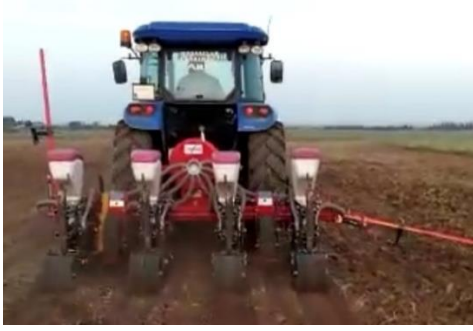
Şekil 1. Çift sıra ekim makinası tarla uygulaması ve ekici ünite görünümü
