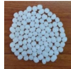
Şekil 1. HDPE granül hammadde (Akdoğan, 2019)
