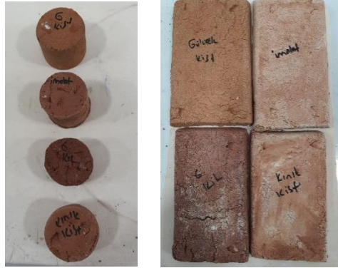
Şekil 16. Kiremit Üretiminde Kullanılan Hammaddelerin ve bünyenin pişmiş örnekleri
