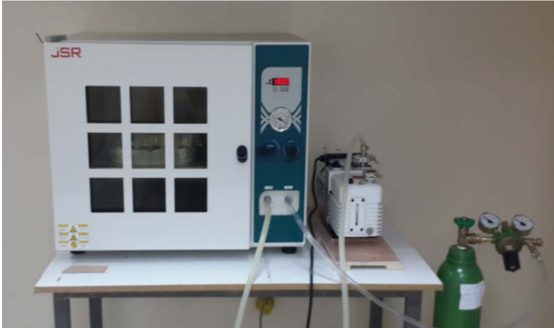
Şekil 2. Çalışmada kullanılan vakumlu etüv, vakum pompası ve gaz beslemesi
