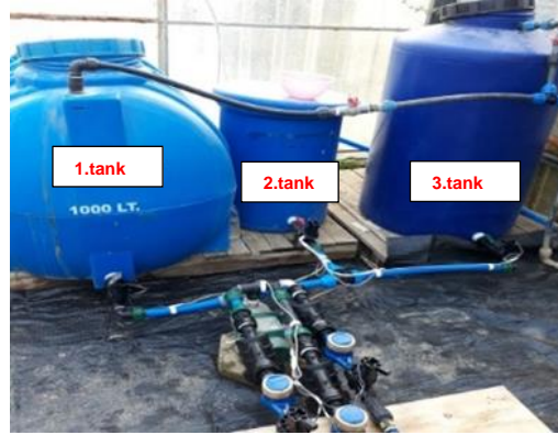
řekil 1. Sulama sistemine iliřkin damlatıcı - lateral boru hattı ve besin zeltisi tanklarına (1., 2. ve 3. tanklar) iliřkin grnm
