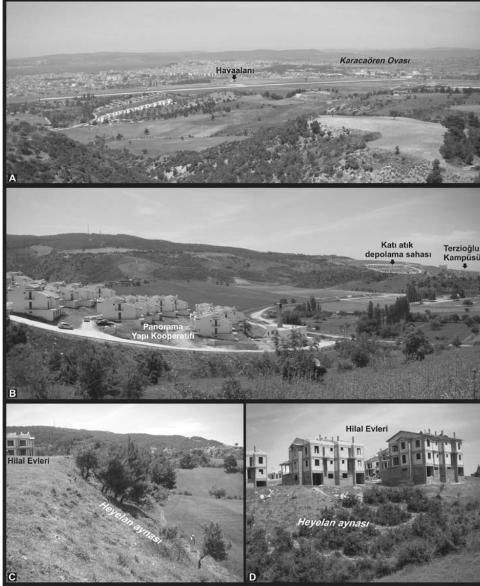
Şekil 9: Çanakkale'nin Karacaören Ovası Yönündeki Gelişimi (A), Çanakkale Ovası Güneydoğusunda Eğimli Yamaçlardaki Yeni Yerleşmeler, Katı Atık Depo Sahası ve Terzioğlu Kampusü (B), Çanakkale Ovası'nın Güneydoğu Kesiminde Eski Heyelan Sahasında Yeni Toplu Konutlar (Hilal Evleri) (C ve D). Bu Kısımda Binalar 8m Yüksekliğinde Bir Heyelan Aynası Üzerinde Yer almaktadır.
