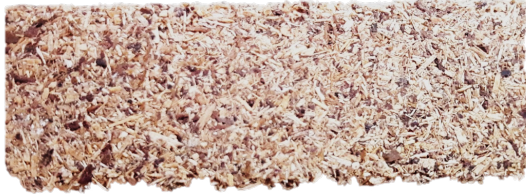
Şekil 2. Üretilen yonga levha yüzeyinin makroskopik görüntüsü Figure 2. Macroscopic view of the produced particle board surface
