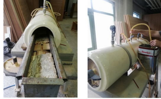
Şekil 1. Empenye işlemi Figure 1. Impregnation process
