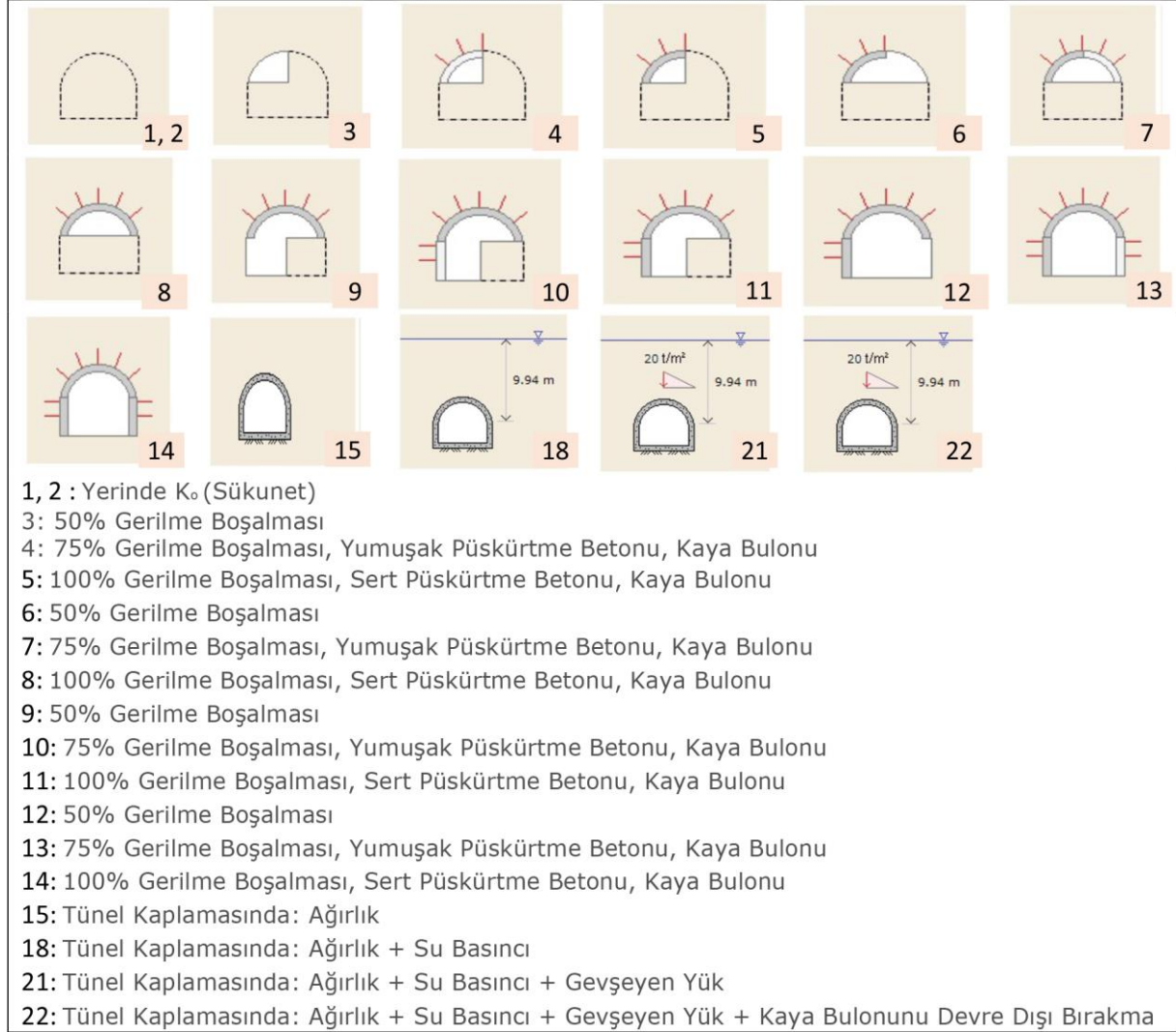
Şekil 3. Tasarlanan tünelin kazı adımları.
