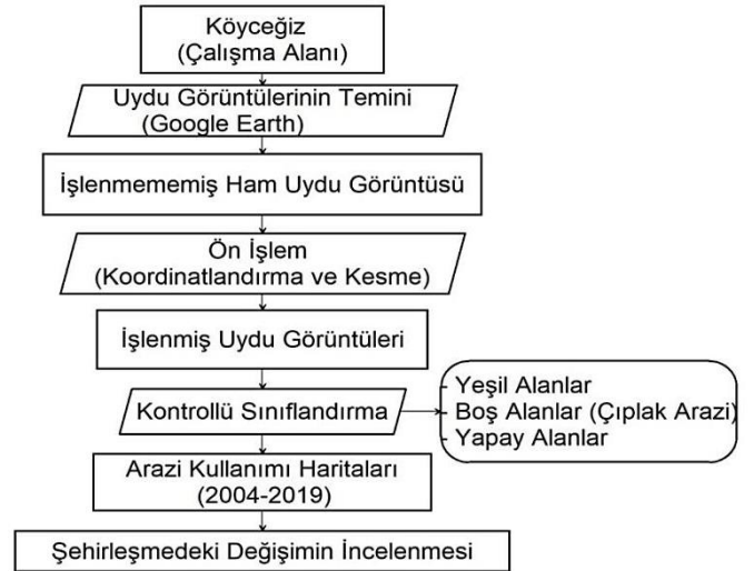
Şekil 2. Çalışmada uygulanan yöntemin akış şeması (Figure 2. Flow chart of the method applied in the study)
