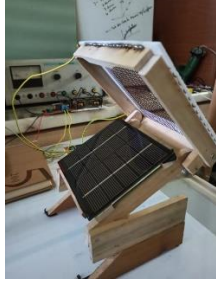
Şekil 2. Elektrostatik temizleme mekanizmasının yapısı.
