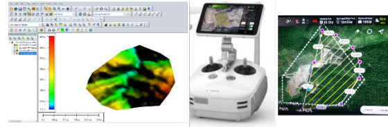
Şekil 3. SYM verisi elde edilmesi ve uçuş planının hazırlanması
