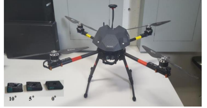
Şekil 2. Eğimli yerleştirilmiş pervaneler ve farklı açılarda eğimli motor yatakları (Figure 2. Tilted propellers and inclined motor bearings at different angles) [7]
