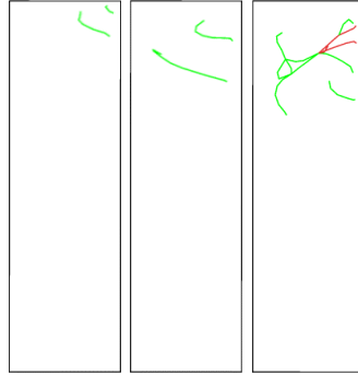
Şekil 6. Tek kristal Ni nano telinin zor-zorlanma eğrisinde a-c noktaları için elde edilen atomik konfigürasyonların DXA analizi sonucu Shockly kısmi dislokasyon çizgilerinin yapı içerisindeki gelişimi.
