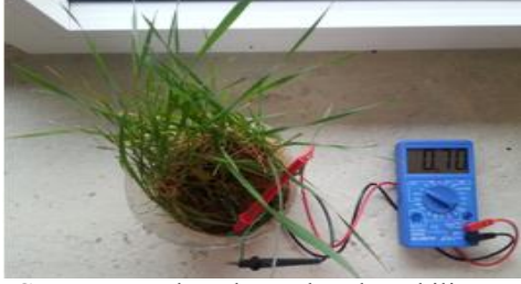
Şekil 15. Çeşme suyuyla sulanan buğday ekili sarı topraktan elde edilen volt değeri
