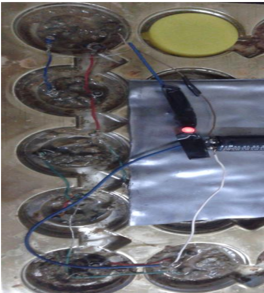
Şekil 12. Sarı toprağa sabunlu su eklenmesi sonucu oluşan pil hücrelerinin karışık bağlanması
