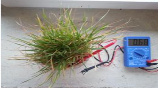
Şekil 17. Sabunlu suyla sulanan buğday ekili sarı topraktan elde edilen volt değeri
