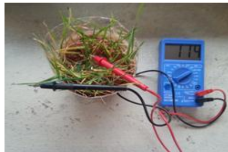
Şekil 22. Sabunlu suyla sulanan buğday ekili kırmızı topraktan elde edilen amper değeri
