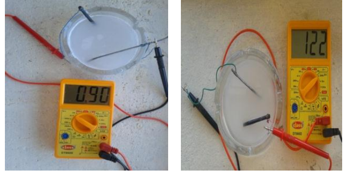
Gerilim (Volt) Değeri Akım (mikro Amper) Değeri Şekil 8. Sabunlu suya çelik-grafit elektrot yerleştirildiğinde üretilen elektriksel değerler
