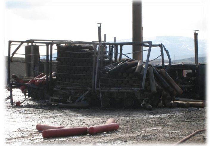
Resim 4: Manifoldlu tüp demeti kazasına ilişkin bir fotoğraf
