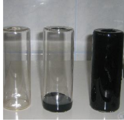
Şekil 3. Dönel ince film etüvü ve deney öncesinde ve sonrasındaki şişelerin durumu.
