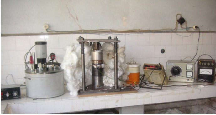
Şekil 2. Mukayese yöntemiyle ölçüm yapılan deney sistemi.
