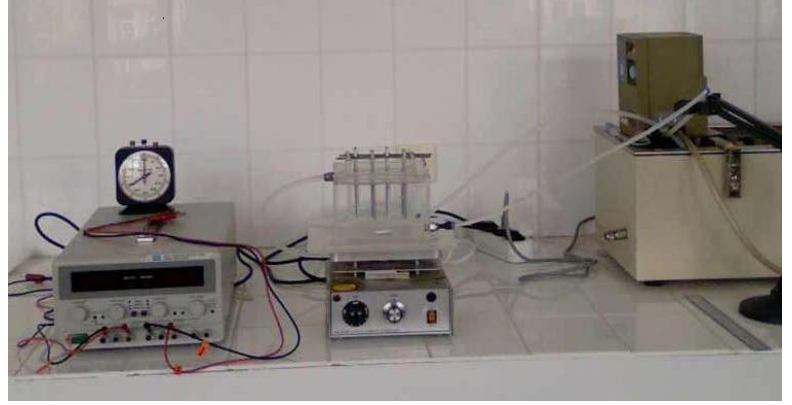
Şekil 1. Deneyel çalışmada kullanılan elektrokoagülasyon deney düzeneğinin şematiği ve fotoğrafı
