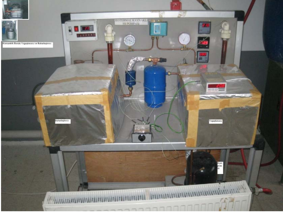
Şekil 4. Deney tesisatının görünüşü
