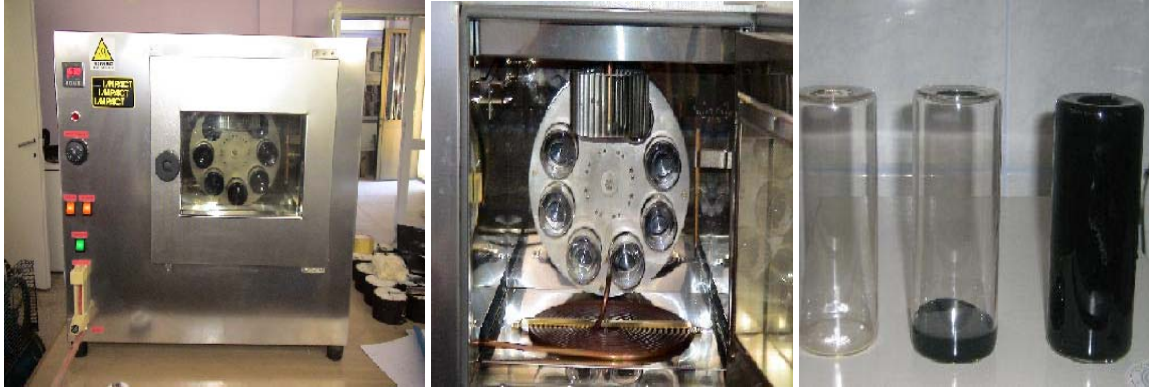
Şekil 1. Dönel İnce Film Etüvü ve Deney Öncesi ve Sonrasında Şişelerin Durumu.
