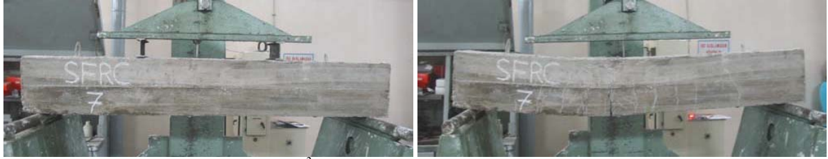
c. 60 kg/m 3 dozajlı çelik lif katkılı betonarme kiriş yüklemesi
