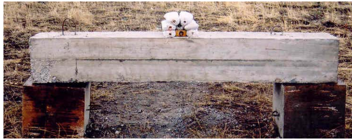
Şekil 4. Betonarme kiriş patlatma deney düzeneği.
