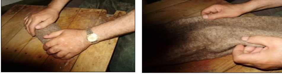
Resim 12. Sikkenin elde pişirilmesi işlemi
