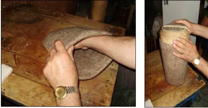
Resim 13. Sikenin kalıba alınma işlemi
