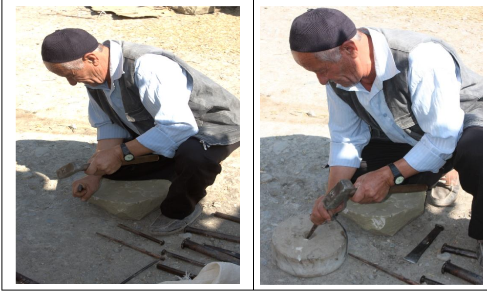
Foto 5-6: Kösüre yapımında kullanılan aletler ve kösürenin yapım aşamaları
