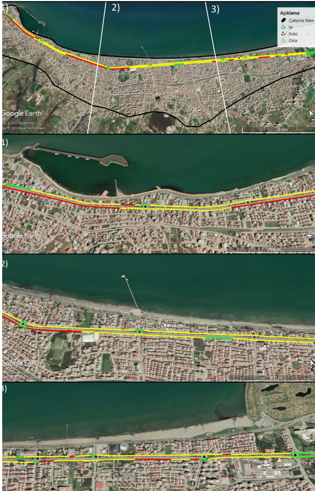
Şekil 2. Atatürk Bulvarında Kaldırımların Engelliler için Uygunluk Durumu
