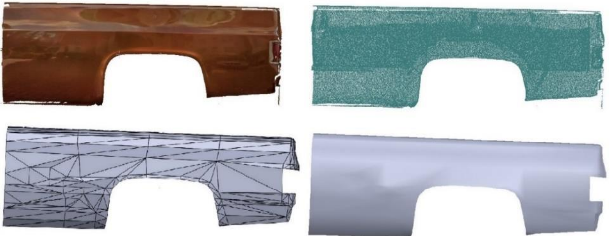
Şekil 10. Otomobile ait sol arka çamurluğunun bilgisayar destekli çizimi
