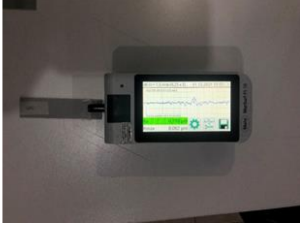
Şekil 4. Deney numunesi ve yüzey pürüzlülük cihazı (Test sample and surface roughness device)
