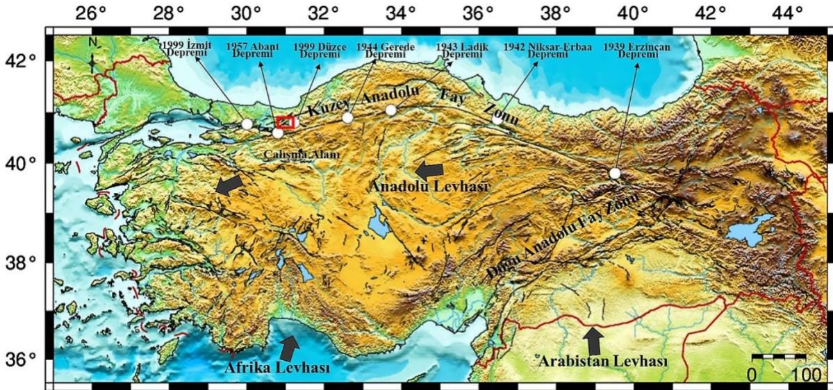
Şekil 1. Türkiye'nin sismotektonik haritası. KAFZ boyunca M > 7 olan depremler. Kırmızı kare çalışma alanını; büyük oklar levhaların hareket yönünü göstermektedir (Faylar, Emre vd. 2013'den [21] değiştirilerek alınmıştır).
