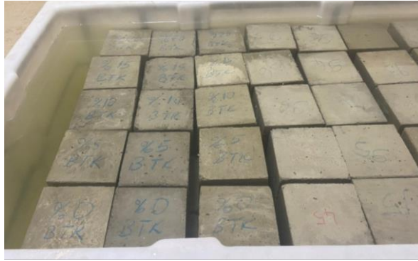
Şekil 4. Üretilen beton numuneler
