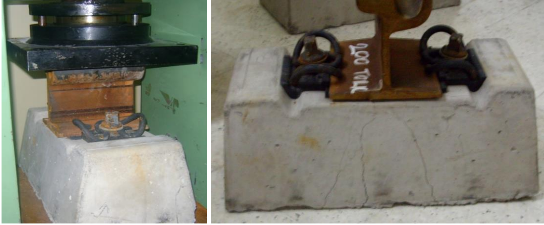
Şekil 10. Traverslerin basınç dayanımı deneyi
