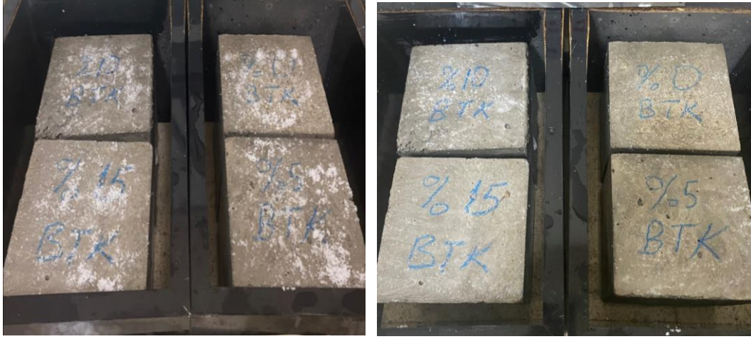
Şekil 6. NaCl ham tuz konsantrasyonu ile numunelerinin donma çözülme döngüsü
