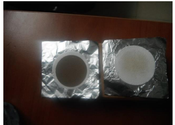
Şekil 3. Filtreleme sonrası Filtre de kalan askıda katı maddeler
