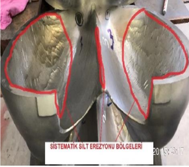
Şekil 10. Çark Kaşıklarında sistematik erozyon
