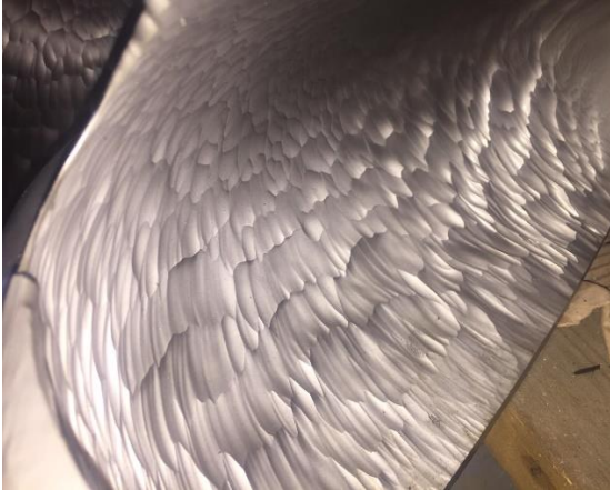
Şekil 19. Kaşık içi aşırı erozyon
