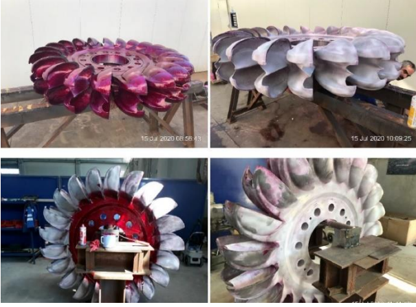
Şekil 28. Tamirat Sonrası PT kontrolü
