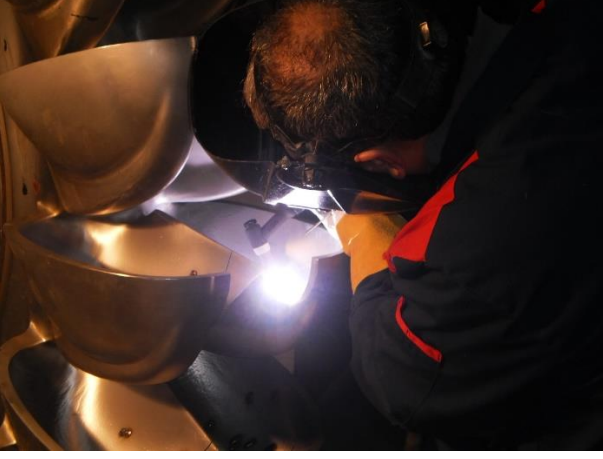
Şekil 13. Çark Kaşıklarında kaynak öncesi ısıtma işlemi
