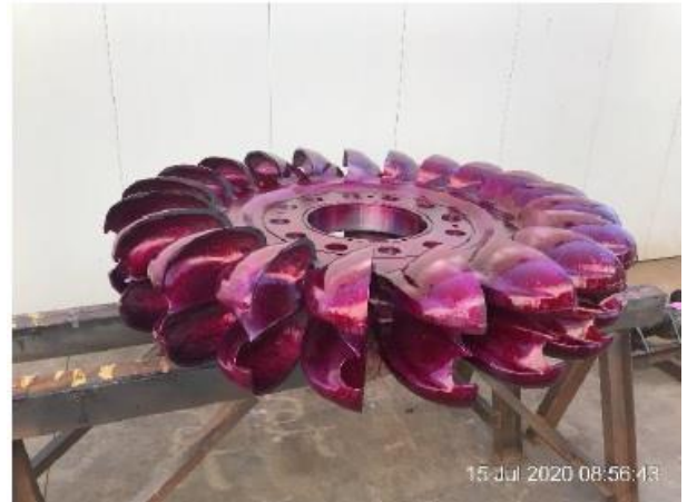
Şekil 27. Tamirat Sonrası PT kontrolü
