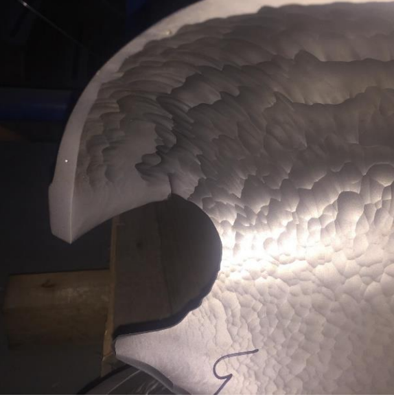
Şekil 18. Kaşık içi aşırı erozyon
