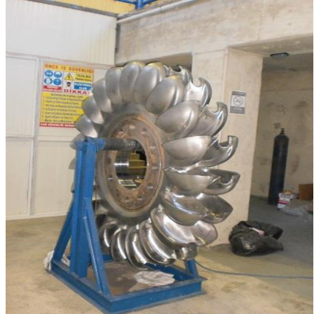
Şekil 1. Pelton Çark Genel Görünüm
