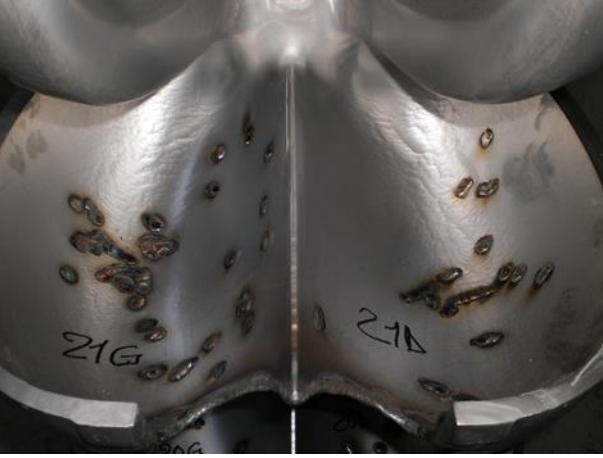
Şekil 14. Çark Kaşıklarında TIG kaynak dolgusu
