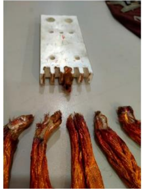
Şekil 4. Çekme test işlemi ardından numune
