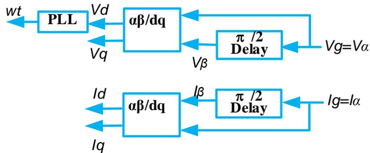
Figure 5. Single phase dq transform block diagram.
