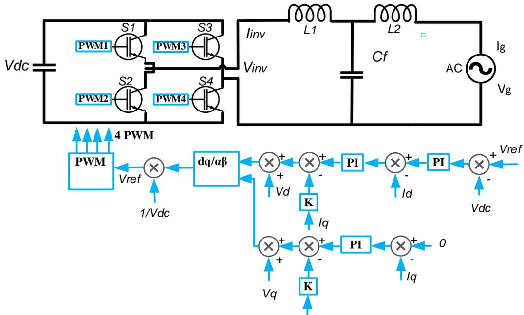
Figure 6. Single phase dq current control block diagram.
