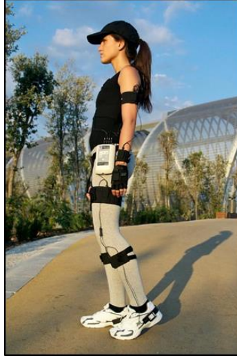
Şekil 4. Atalet hareket yakalama sistemi [140].
