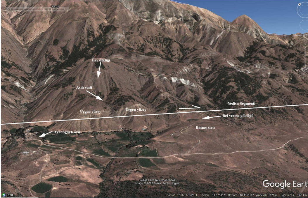
Foto 5. Yedisu Havzası (Bingöl)'nin Batısında Ayanoğlu Köyü Civarında Aktif Faylanmayı Gösteren Basınç sırtı, Üçgen Yüzeyler, Bel Verme Gölcüğü ve Fay Dikliği
