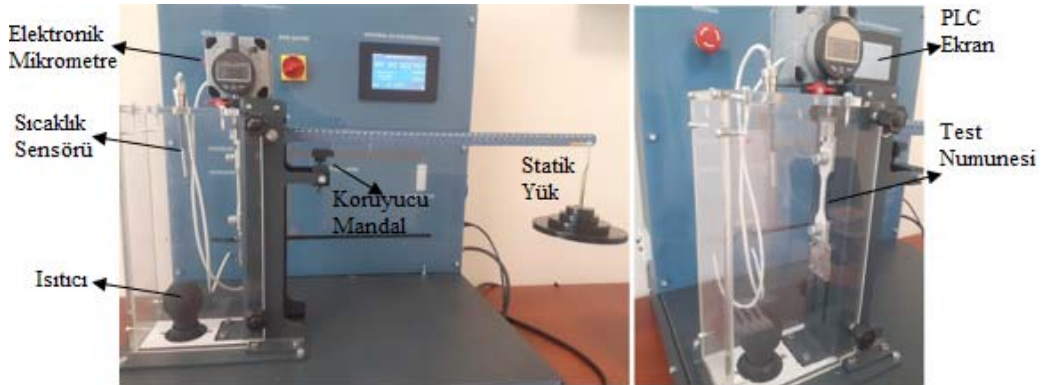
Şekil 3. Sürünme test cihazı genel görünümü (General view of creep test device)
