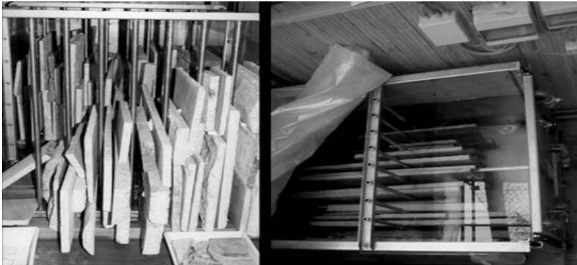
Şekil 10: Miracoli'nin mermerlerinin tuz birikintileri arındırma işlemi (URL-7)
