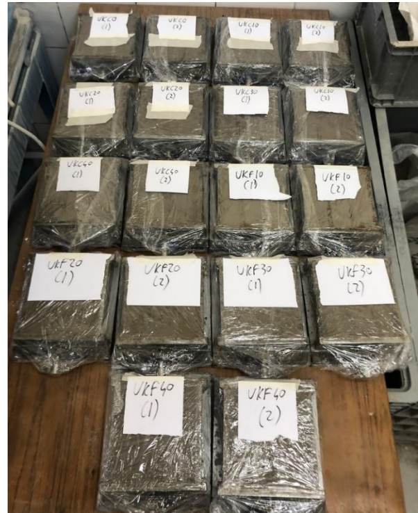
Şekil 1. Sızdırmazlık kürü işlemi
