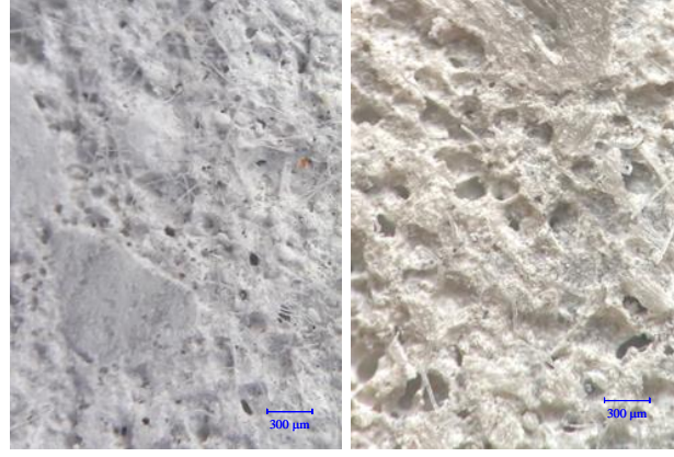
(c). PVA6-1.0 örneği matris yapısı. (d). PVA6-1.2 örneği matris yapısı.
