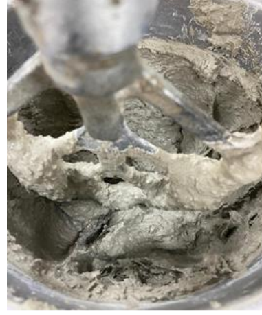
Şekil 3. Yaş harç karıştırma işlemi görüntüsü.
