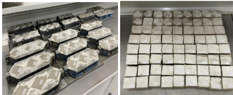
Şekil 4. ÇEHH test örneklerinin kalıplanma ve kalıp sonrası genel bir görüntüsü.
