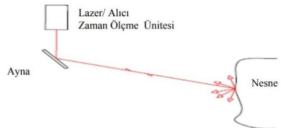
Şekil 10. Lazer ışını gidiş geliş zamanı ile işlem yapan tarayıcıların çalışma prensibi (Gümüş & Erkaya, 2007).
