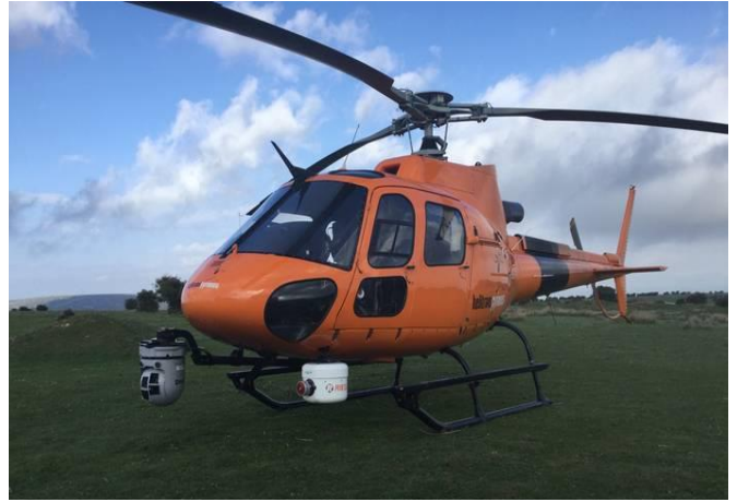
Şekil 5. Havasal lazer taramanın helikopter örneği (Emigrup, 2021).
