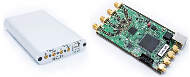
Şekil 2. DRS4 Evaluation Board versiyon 5.1
