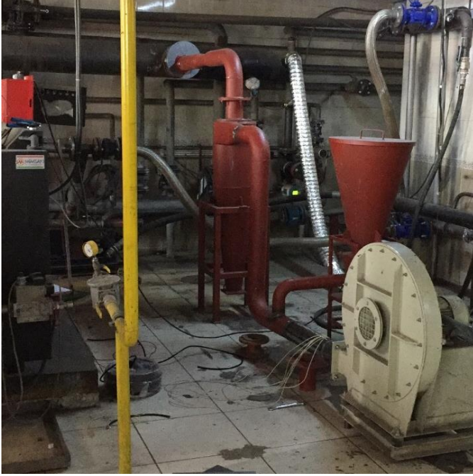
Şekil 8. Siklon Deney Seti (Figure 8. Cyclone Test Kit)
