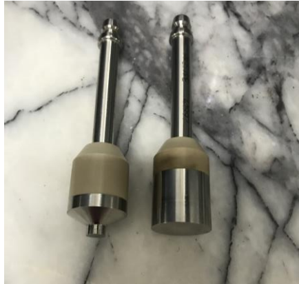
Şekil 2. Çalışmada kullanılan 8 ve 25 mm’lik DSR başlıkları
