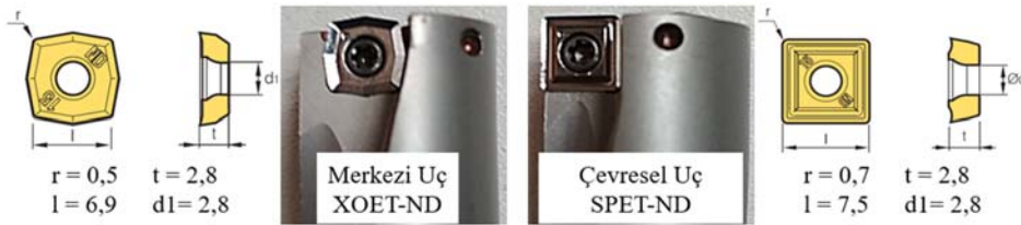
Şekil 3. Sol-Merkezi Uç, Sağ-Çevresel Uç (Left-Center insert, Right-Peripheral insert)
